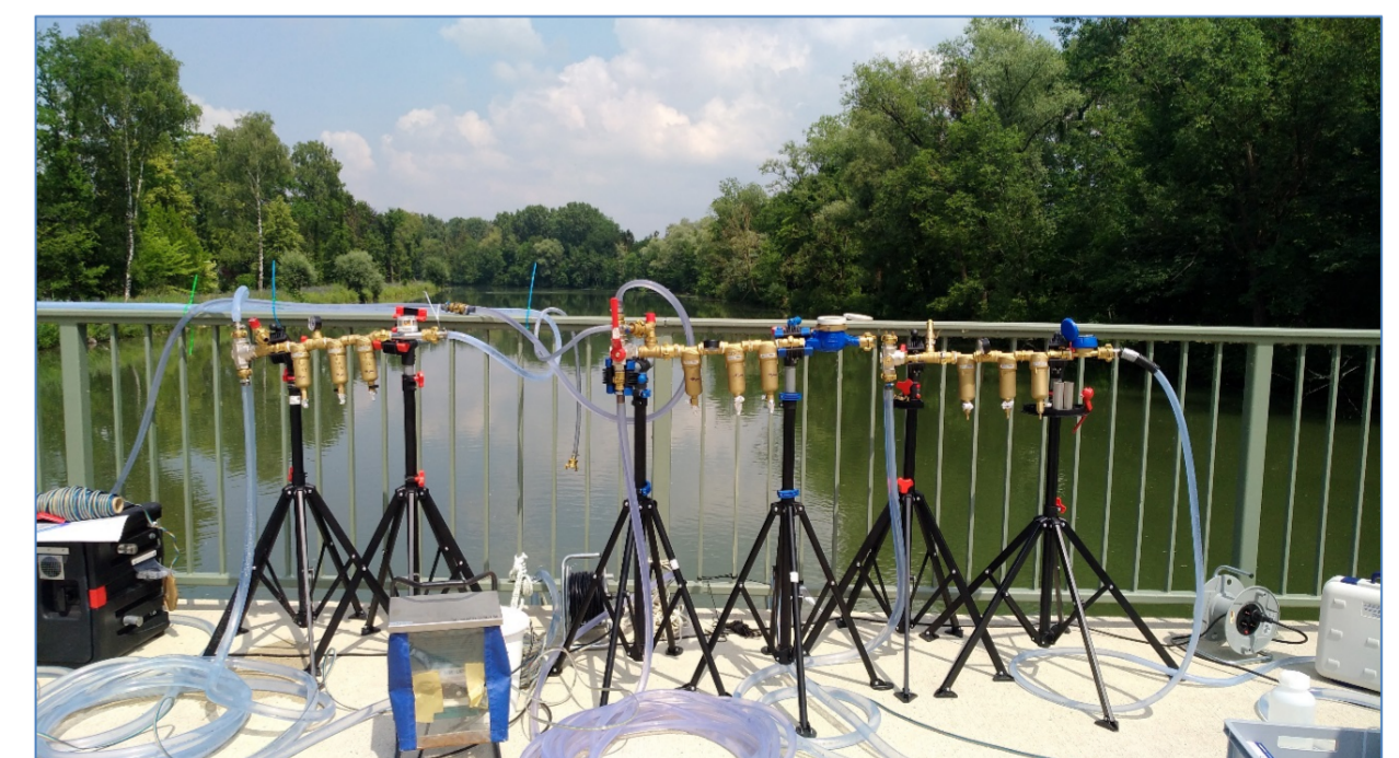
Abb. 4: Probennahme aus unterschiedlichen Gewässertiefen (MicBin)
