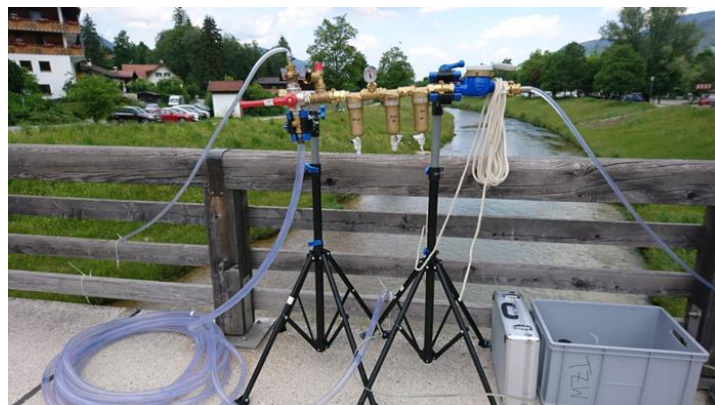
Abbildung 1: Zur Probenahme wird eine definierte Wassermenge (> 500 l) über eine Filterkaskade gepumpt.
