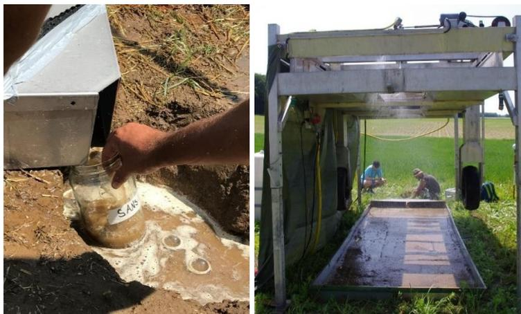
**Abbildung 30:** Abflussblech (links) des Schwenkdüsenregners (rechts) für die Regensimulation (UniA)
