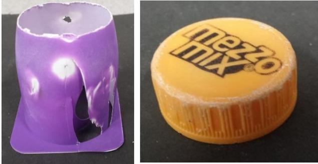
**Abbildung 55:** Abriebspuren bei einem PS Becher und einem HDPE Flaschendeckel. (UOS)
