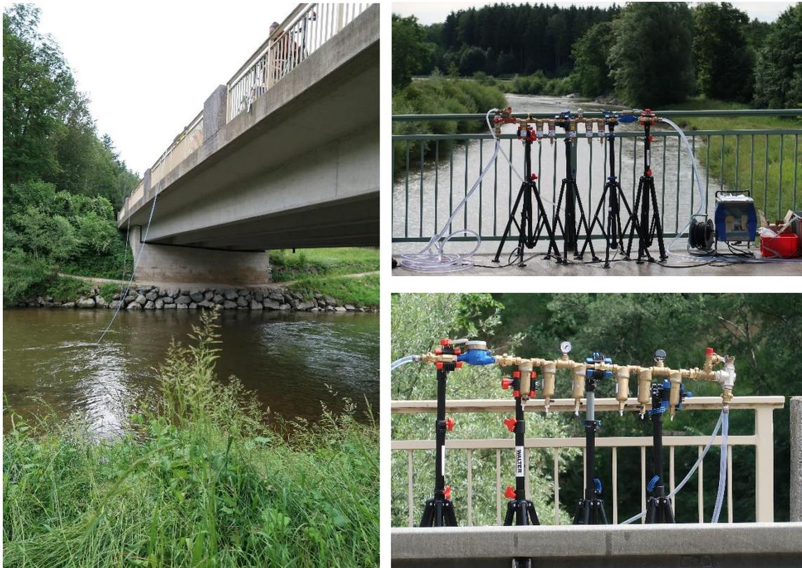
**Abbildung 12:** Mikroplastikpartikel-Probenahme mittels fraktionierender Filtrationskaskade von einer Brücke aus (TZW)
