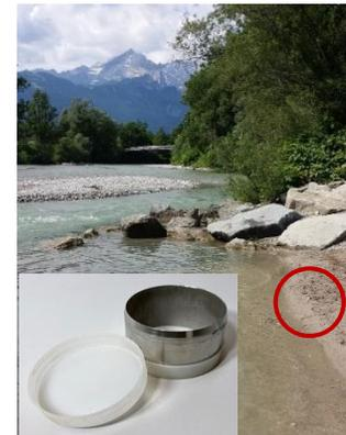
**Abbildung 62:** Stechzylinder und Probenstelle für Auensediment an der Loisach (BfG)
