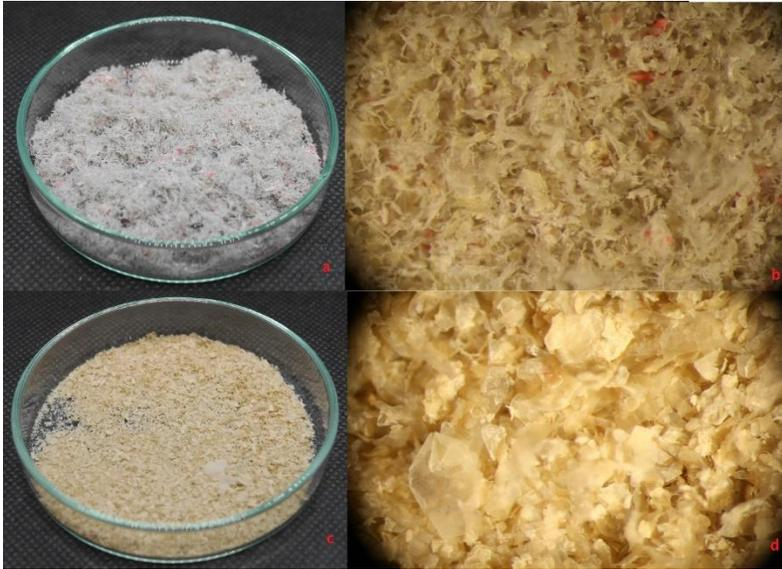
**Abbildung 57:** Verschiedene Fragmentierungsmuster der PE-Tütenproben in Kollisionsversuchen. Es bildeten sich entweder längliche Fragmente, die sich verknäuelten oder sehr kleine quadratische Fragmente. (UOS)
