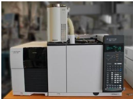
**Abbildung 3:** Pyr-GC/MS (Pyrolyse: Multi-shot Pyrolyzer EGA/PY-3030D von Frontier Laboratories – GC/MS: GC 7890B/MSD 5977B von Agilent) (BfG)
