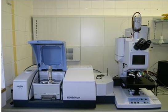
**Abbildung 7:** FTIR-Spektrometer (links) mit angeschlossenem Mikroskop (rechts) (LfU)
