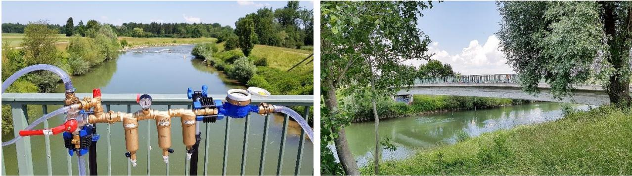
**Abbildung 61:** Probenahmeapparatur (links) und parallele Beprobung eines Querprofils mit drei Apparaturen (rechts) (UOS)
