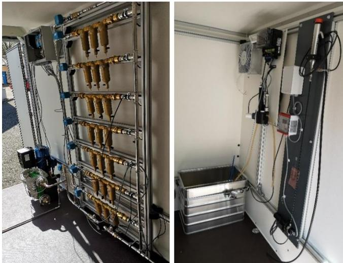
**Abbildung 93:** Probenahme-Apparatur mit Filtrationskaskaden (links); Multisensoranlage und Partikelzählgerät (rechts) (TZW)
