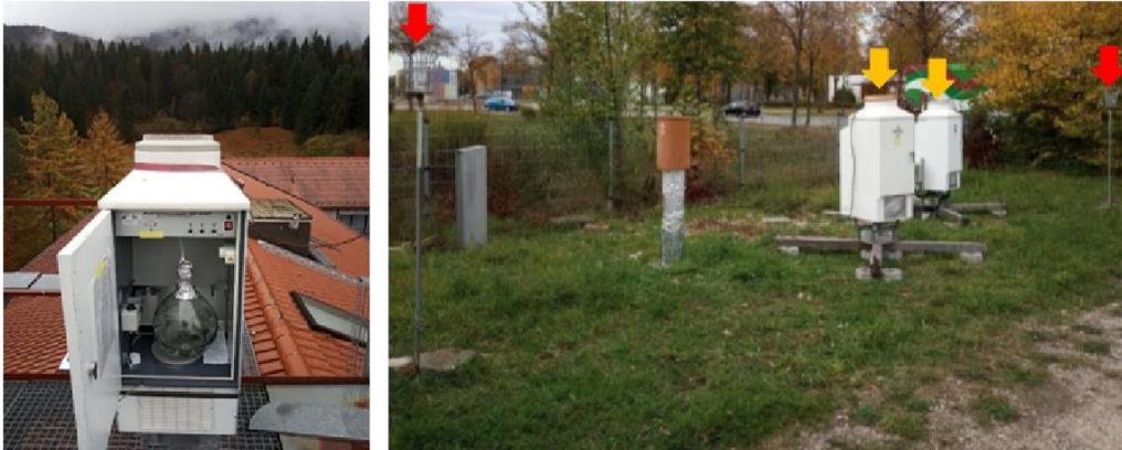
**Abbildung 15:** e-Bulk-Sammler mit Sammelgefäß (links) und Versuchsaufbau für Parallelsammlung mit zwei e-Bulk- (gelb) und Bergerhoff-Sammlern (rot) (rechts). (LfU)
