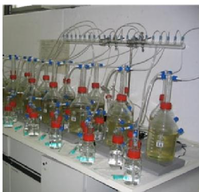
**Abbildung 59:** Testsubstanz: LKW-Reifenabrieb (oben) (LfU), Aufbau eines CO<sub>2</sub>-Entwicklungstests (unten) (Hydrotox GmbH)
