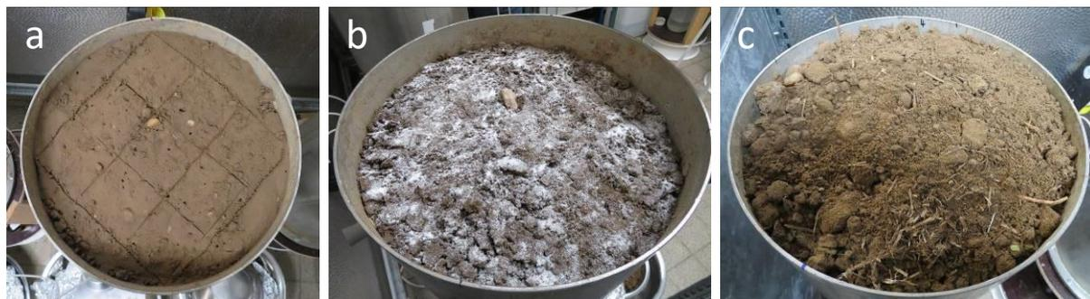
**Abbildung 36:** Kleinlysimeter mit erkennbaren Wurzel- und Wurmgingen und Raster zur MP-Applikation (a), nach Applikation von Mikroplastik (b) und vor Start des Beregnungsversuchs (c) (LfU)
